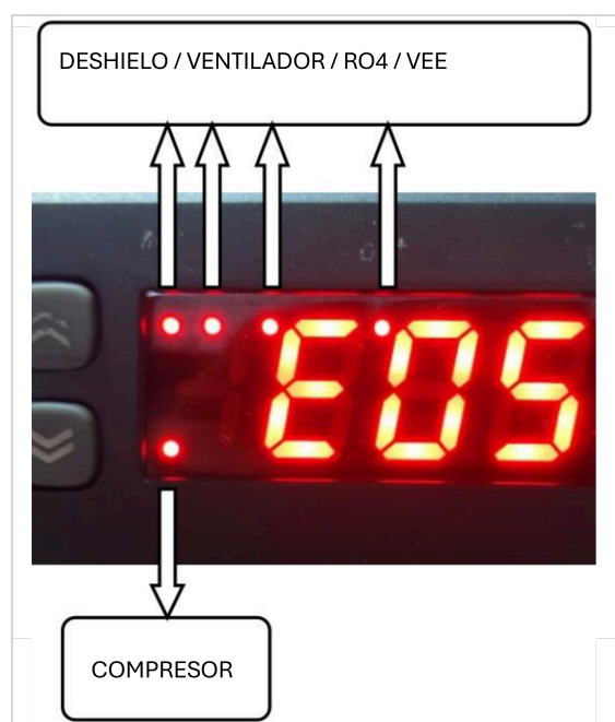
Figura 2 — Salidas asociadas al indicador de compresor y deshielo/ventilador/RO4/válvula electrónica
